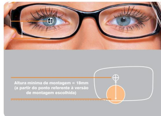
Obs.: Devido a convergência necessária para a visão intermediária, a DNP de longe deve ser alinhada no traço vertical que está posicionado acima dos pontos de montagem, deslocado a 1mm dos mesmos.
