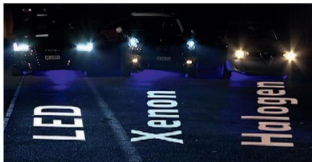
Figura 8: Comparação de diferentes temperaturas de cores de faróis de LED, HID/xenônio e halogênio
